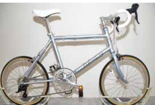
▲Dahon隱藏式的折疊機構，讓整車外觀變得簡潔，剛性變得更好。
