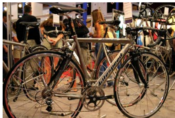
▲Litespeed的Ultimate，車架採用GET鈦合金管材，再配上碳纖維後上叉。
