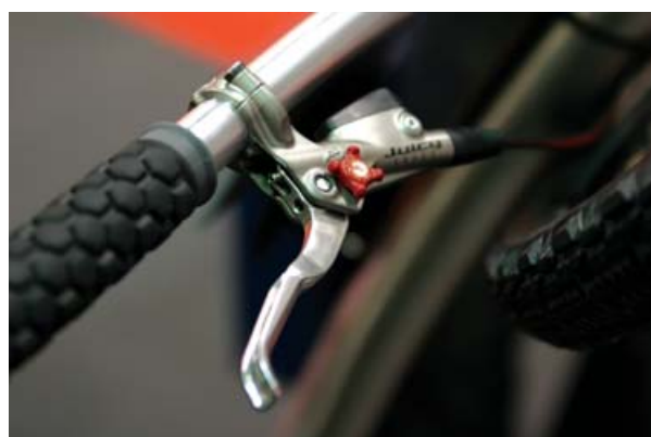
▲Avid新推出的Juicy油壓剎車，有多種方便的調整功能，更換來令片也相當容易。
