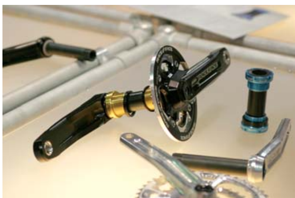
▲Race Face的X Type同樣有外鎖式培林，整合式中軸固定於曲柄退側，與Shimano的設計有異曲同工之妙。
