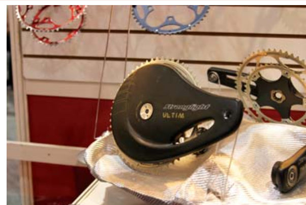
▲Stronglight的計時賽齒盤Ultima，強調剛度與低風阻。
