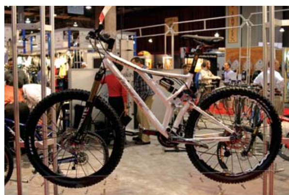
▲Tomac推出的ELI具有4吋至5.5吋的可調行程，屬全功能車取向。
