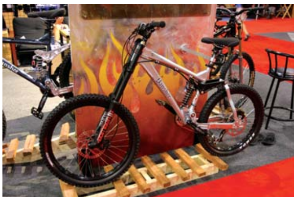
▲2004年的Banshee Scream，在五通部位以CNC製作的加強片補強，更為強悍。
