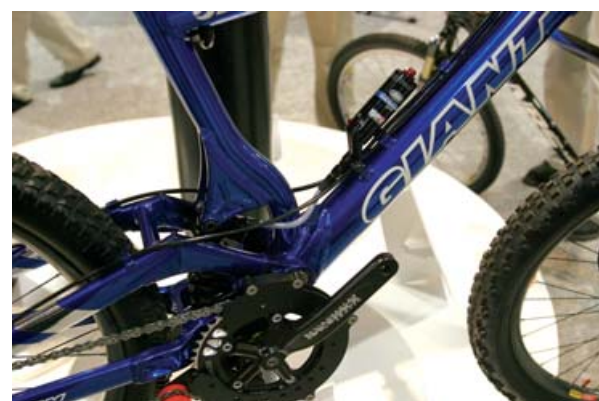
▲2004年版的Giant DH Team，將後避震器的油壺置於車架下管上方，使調校更方便。
