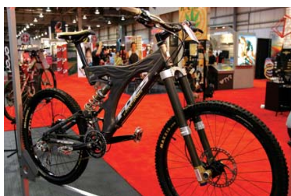
▲Foes的Inferno車架一體成型，車身還壓出漂亮的火燄造型。
