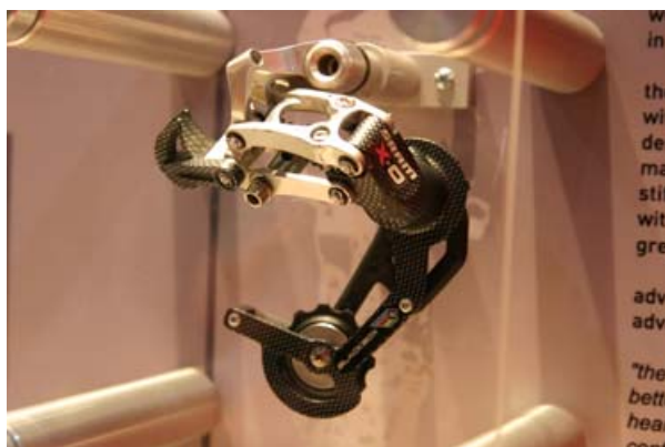
▲SRAM的X.O後變速器，此款為碳纖維版，導輪支架部分為碳纖維材質。
