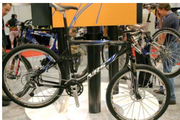
▲Giant NRS AIR頂級配備，車架前三角採用碳纖維，重量更往下探底。
