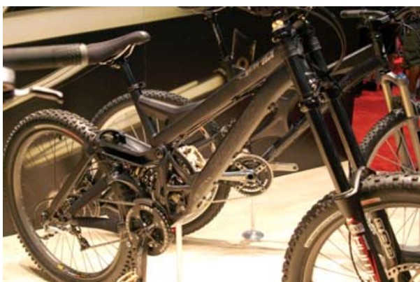
▲Specialized的新款下坡車Demo 9，後搖臂有類似於雙層螞蟥腿的造型。
