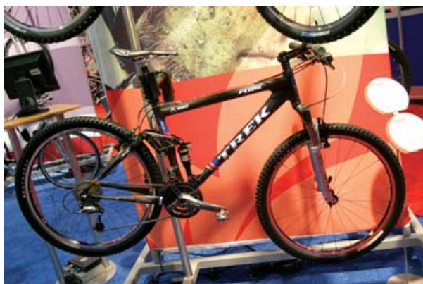
▲Trek的Fuel 100，車架使用OCLV 120碳纖維技術製成。
