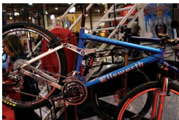
▲Ellsworth的Truth，具有4英吋的後避震行程。
