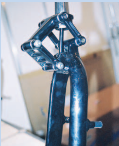
▲申弼 (TGs) 推出的四連桿避震前叉設計，重1.17公斤，行程60mm。
