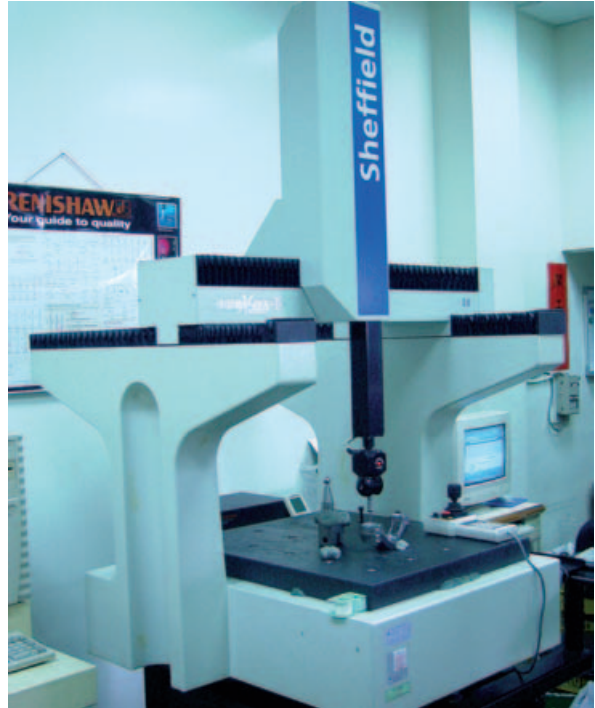
▲億豐的三次元量測設備(CMM)，可做幾何公差的檢測。
