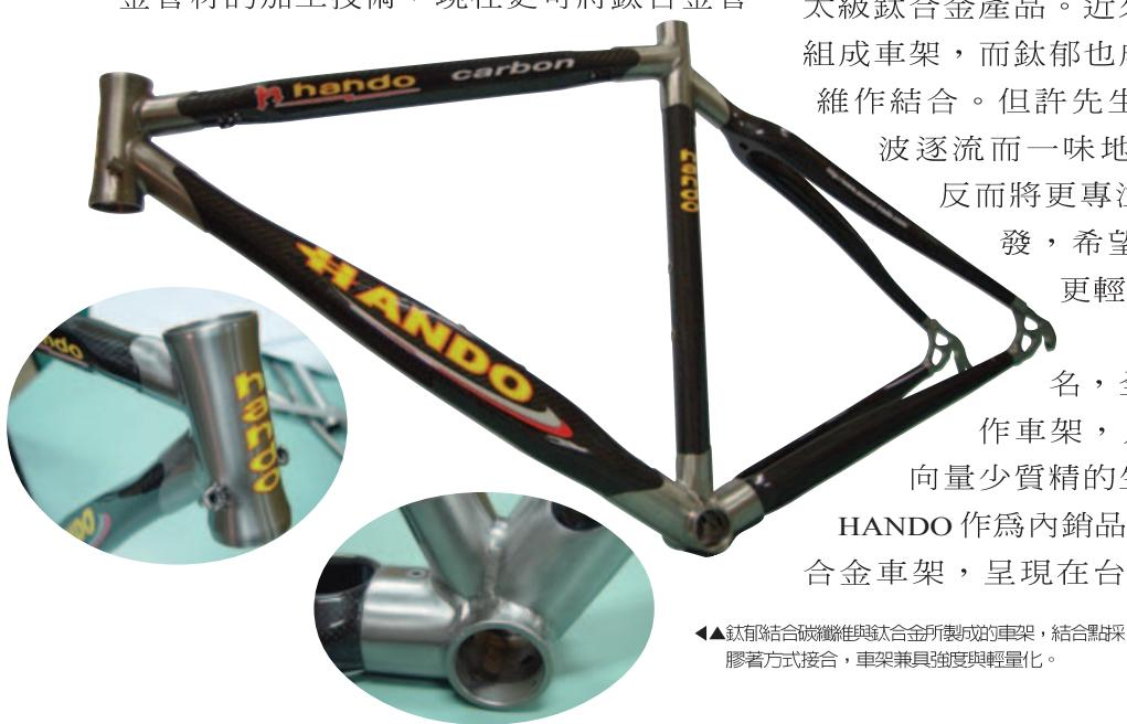
▲鈦郁結合碳纖維與鈦合金所製成的車架，結合點採膠著方式接合，車架兼具強度與輕量化。
