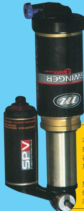
**SPV Swinger-Air避震器的基本**重255公克，近向氣壓槽及SP氣閥都可調校。初次調校須花一些時間，因為必須調整正向壓力及SP逆向壓力。
