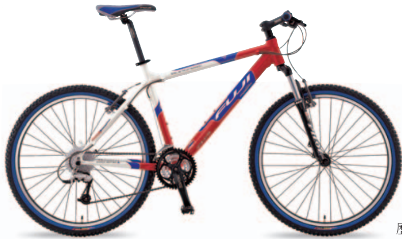
▲愛地雅與Fuji策略聯盟並為其代工生產自行車，圖為其採用Altair 2 Tubing車架材質設計的輕量化登山車。
