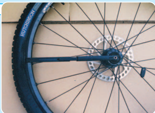
▲將拆胎棒尾端置入花鼓軸，以利繞行。
