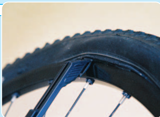
▲只要轉動拆胎棒，不管是順時鐘或逆時針轉動，皆可輕易地將外胎拆下。
