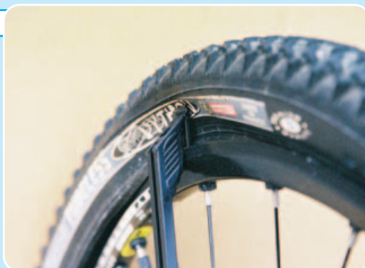
▲裝胎時，用頭端尾部，勾住輪圈，轉動拆胎棒即可將外胎裝入輪圈內。
