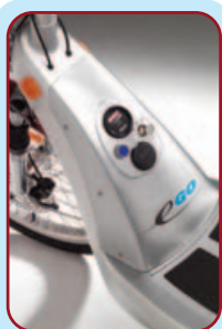
▲數位化 LED 電量表、電源開關、快速及慢速模組，讓使用者輕鬆上路。
