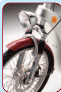
◀避震前叉加上高強度雙層鋁輪圈，提供安全且舒適的騎乘感受。
