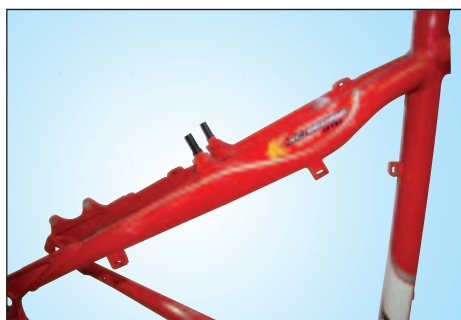
▲卜威運用液壓成型造就流線美觀的車架後上叉造型。
