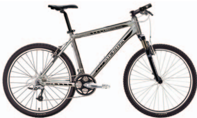
▲美利達新系列的車款，大量運用最新HFS (Hydro Forming System) 液壓成型管材技術，增添了車架在外觀上藝術化的美感與質感。
