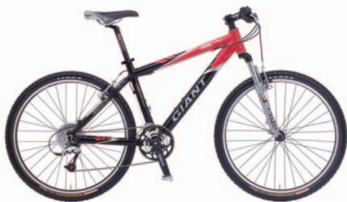
▲巨大的高檔鋁合金車架也陸續運用液壓成型技術的設計，為車架創造出高質感與更多的附加價值。
