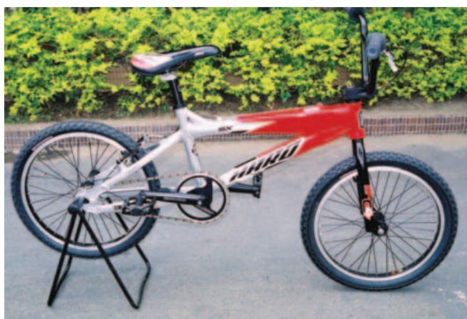
▲Haro的新SX Comp BMX車款的车架管也運用鋁合金液壓成型技術。
