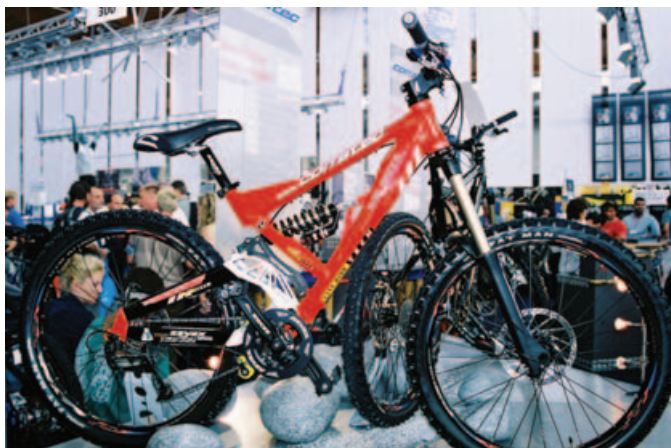
▲Corratec今年開始使用液壓成型管，並首度推出DH車款Bump Machine，後避震行程140mm，前行程130mm。
