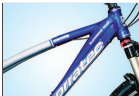
▲一直以香蕉車型為招牌的Corratec，2003年開始運用液壓成型下管。
