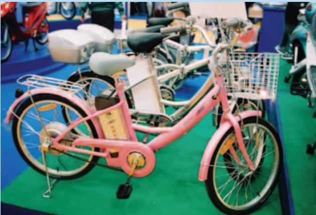
▲大陸錦新推出的2004年鎳氫電池輕便車，採人性化設計，配上有刷無齒電機及1比1的助動比例，實用性極高。
