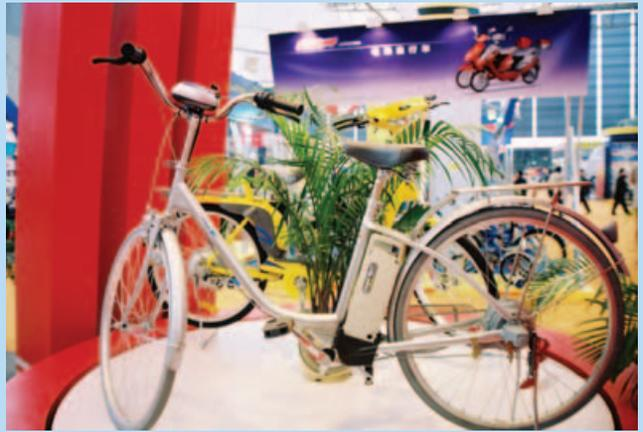
▲千鶴新款TDF320Z除強鋼非輕學化的電動自行車設計，還有鋰電池或鎳電池可供選配。
