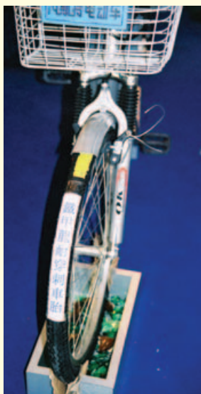
▲建大專為電動車設計的鐵甲龍耐穿刺車胎。
