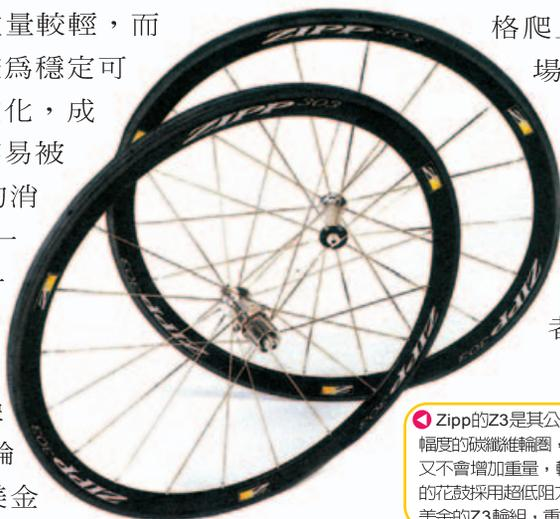
◀ Zipp 的 Z3 是其公司碳纖維輪組產品線中的頂尖產品。採用中幅度的碳纖維輪圈，內含發包成型的彈性體，可吸收細微震動卻又不會增加重量，輪圈於車表面作了矽及石墨的特別處理。Z3 的花鼓採用超低阻力的陶瓷培林及碳纖維軸心，一組價格 3000 美金的 Z3 輪組，重量僅有 1065 公克。
