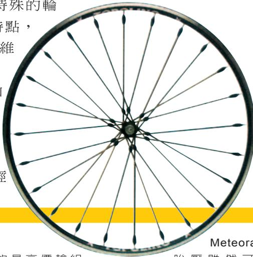
Topolino 以其獨特的複合材料技術，製造出輕量及強度兼具的輪組，以滿足那些想要與眾不同的騎士。Topolino 輪組的輻條採用碳纖維及 Kevlar 纖維以達到輕量、強度及舒適的騎乘感。輻條採連貫的方式，由輪圈的一頭穿過複合材料製成的花鼓後連到輪圈的另一頭，輻條兩端及交錯的地方採用複合材料以消除應力並確保強度及輕量。一組價格為 849 美金，重量為 1350 公克。
