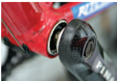
▲培林式中軸內藏至車架五通內部，成熟度高，鎖緊即完成安裝及調整，未來中價位車款可能多採用此種易於安裝及保養的中軸套件。
