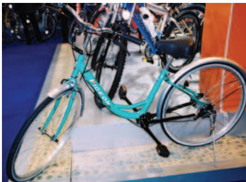
▲中國天津飛輪展出的無鏈式軸傳動自行車，主要針對日本市場，傳動軸由台灣展吉公司提供。
