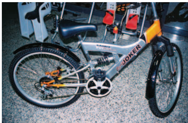
▲瑞振推出適合全避震車使用的最新前後泥除設計，拆裝相當簡便。
