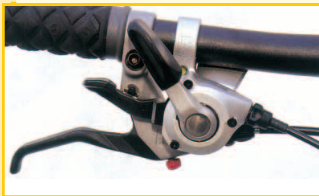
▲全功能終端變速器：Shimano 的 RapidFire-Plus 變速器有一些小缺點，但在多功能和人體工學上的設計仍在變速器排行榜上名列前茅。
