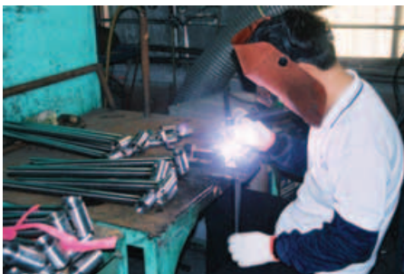
▲鈦合金在焊接時需與空氣隔離。
