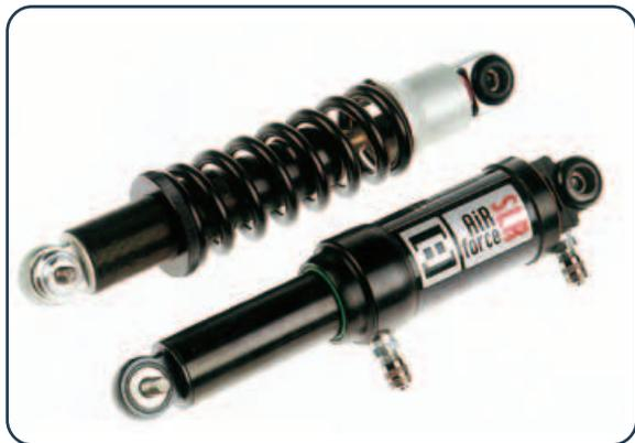
▲南轅北轍：搭配鋼簧避震柱，可使比一前叉又具有驚人的滲透性且極為敏銳，頗適合於追求樂趣的車迷和越野車迷。不同的彈簧，初始應力及可調拉伸式刻度的結合而獲得不同的調校效果，此一前叉又如搭氣壓式避震器，會具備運動剛性及甚為直接的特性，這是健身型車迷和休閒傾向型強車迷的首選產品，其調校功能則來自於正、負向氣壓槽和可拉伸度吸震器的交叉組合。
