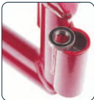
▲缺點少：只有在拆卸時有些問題。很意外的是，軸承並非車削吻合承座，而只是簡單地壓入塗了厚漆的軸承保護套內，如軸承可精確地卡住，其實也無所謂，不過，如果其塗漆很快就脫落，且軸承不另加裝安全措施，而可能在其卡槽內鬆脫的話，就必須更換軸承了，此點是一款昂貴的前叉不應出現的缺失。
