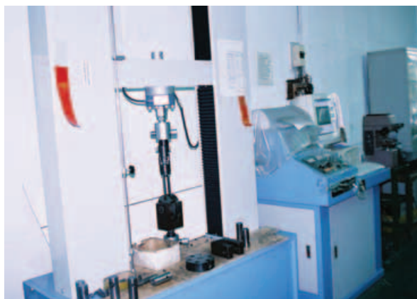
▲台螺廠內還設有獨立的螺栓實驗室，圖為專供拉力及耐力的測試機。
