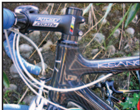
►▲目前僅有部份品牌的車架，針對隱藏式頭管縮小的部份作出補償，以減少前叉墊片的使用
