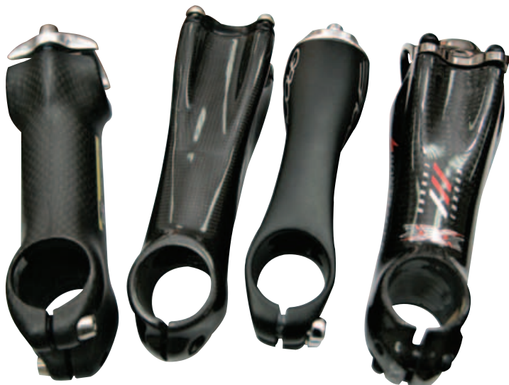
▲全碳纖維的龍頭，將是未來龍頭尺寸可搭配車架造型且時又兼具輕量的解決方案。右二為第一代2D鋁合金龍頭，全碳纖維的龍頭在造型上明顯超越鋁合金龍頭。
