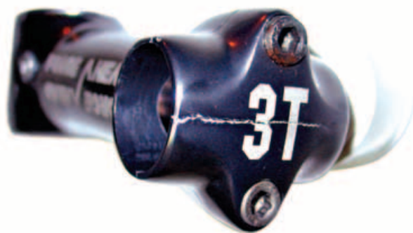
▲龍頭的鎖入必須依照原廠提供的扭力值，以扭力扳手監控，圖為筆者於2001年使用的龍頭，因安裝時鎖緊力量過大，於半年後前蓋產生裂縫。
