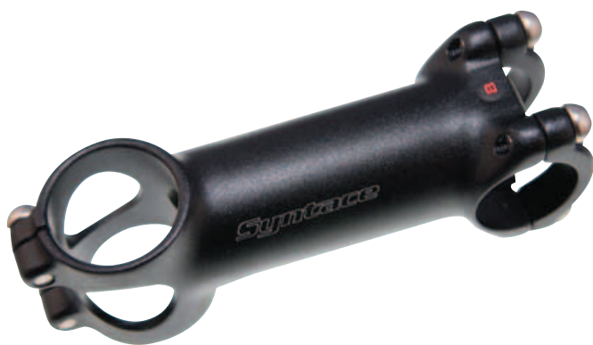
▲Syntace使用其VR3測試機以原有前龍頭作測試，將龍頭作到最精簡的設計，此款F99僅重99公克。
