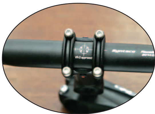
▲Syntace針桿扣環式固定龍頭，設計專用把手，在把手的固定位置上加強補強，並標示特殊記號告知消費者。
