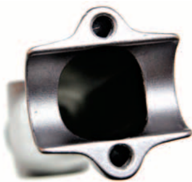
▲兩點式固定的龍頭，為了給予螺牙足夠的材料面積，而影響到內壁的材料厚度，成為輕量化的阻礙。
