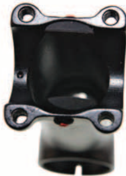
▲四點式固定法，將螺牙固定點移至圓周的四個點，因此不影響內管抽薄的輕量化，在工法上也較易執行。
