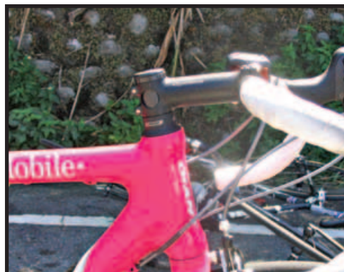
►▲目前僅有部份品牌的車架，針對隱藏式頭管縮小的部份作出補償，以減少前叉墊片的使用
