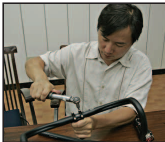
▲PMG 嘉冠公司總經理盧伯英示範以 Syntace 扭力扳手鎖緊龍頭，多數的龍頭扭力值均設定為 8 Nm (牛頓米)。
