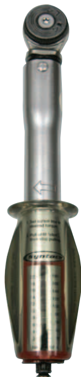
▲ Syntace專為龍頭固定而製造的扭力扳手(2~20Nm)，一般扭力扳手由10Nm起跳，力道較大。
