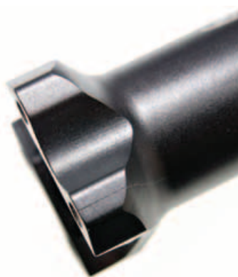
▲鎖入及放螺絲四點式龍頭時，必須採對稱平均方式，圖為因釋放不均勻而造成的裂痕。
