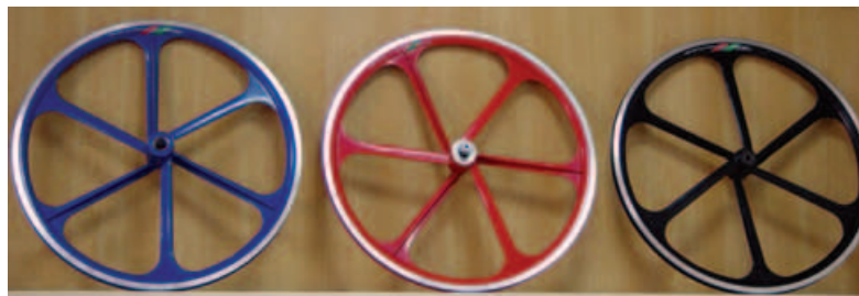
▲▼田霖Teny Rim採用鋁鎂合金的液壓成型無內胎輪組，強調車圈不鑽孔、不打洞，有效解決漏氣的問題。
