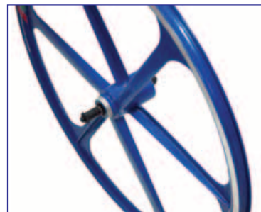
▲▼田霖Teny Rim採用鋁鎂合金的液壓成型無內胎輪組，強調車圈不鑽孔、不打洞，有效解決漏氣的問題。
