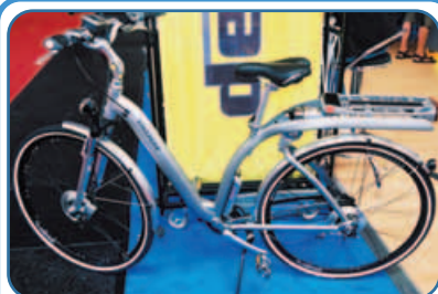
▲全避震的Villiger Lugano SB車整合Shimano的Smover智慧型電空系統。
