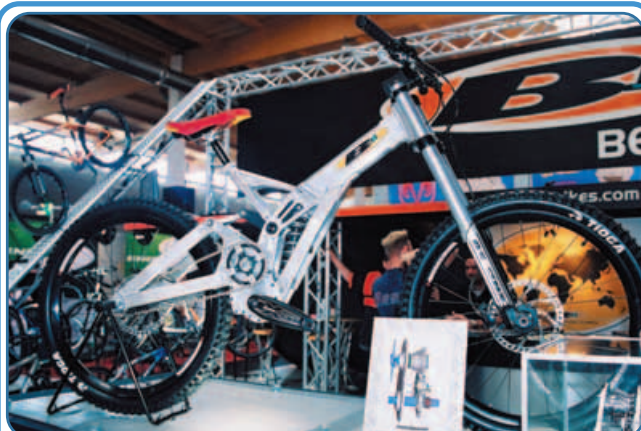
▲B1的內藏式變速系統採用外變速內藏的PeteSpeed設計，不同於Nicolai與GT的機構。
