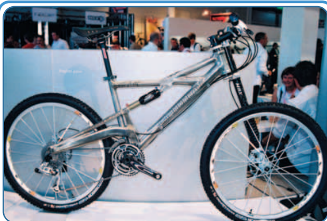
▲Cannondale新款6061鋁合金Enduro車搭配最新單臂避震前叉Lefty Max Carbon，全車重11.6公斤。
