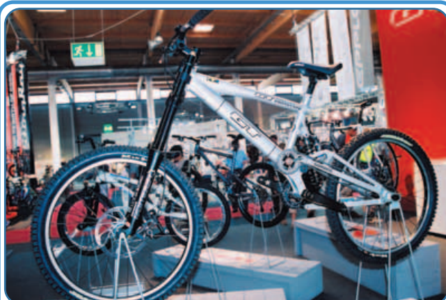
▲GT的T1下坡車(Prototype)採用獨家IT技術的(Internal Transmission)設計，與G-Boxx異曲同工。
