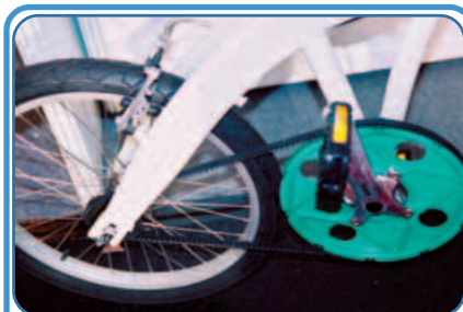
▲賽克展出用在折疊車的皮帶傳動系統。
