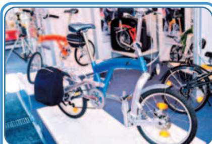
▲外觀流觀的全功能折疊車設計，搭配單邊前叉與碟煞。
