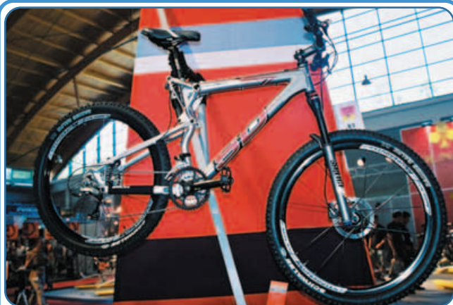
▲Arrow的SD 16採四車桿設計，搭配寬胎與長避震行程。
