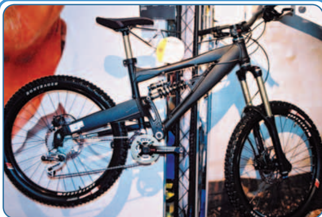
▲Gary Fisher新推出的Freeride車款King Fisher擁有18cm的前後避震行程。
