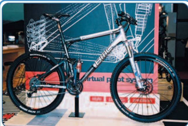
▲BMC推出的第二代後避震虛擬轉點(VPS)設計的鈦合金車款。
