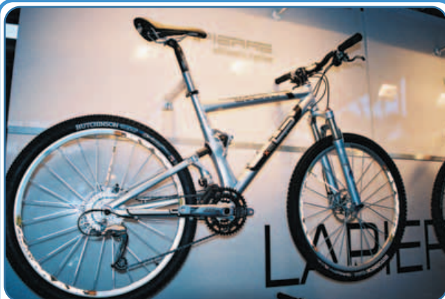
▲Lapierre展出後避震結構設計特殊且運用液壓成型技術的全避震車款。
