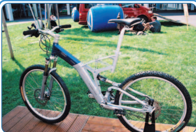
▲Audi的全避震登山車造型流線簡約，採7020 T6鋁合金材質。
