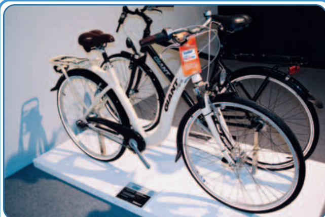
▲Giant Mono採輕量的City車架，後貨架為一體式的設計，且運用走線內藏。
