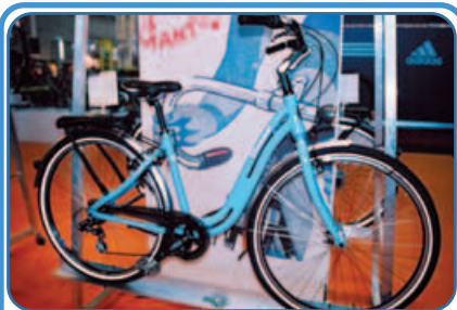
▲Trekking車多將走線內藏以提升美觀與現代感。
