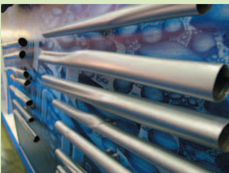
▲Deda拿手的管材，鋁合金管材更使用HF的液壓成型技術，作出多樣的管形。
