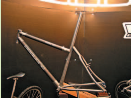
▲量身訂作的鈦合金Paduano為首間將座管整合至車架的車廠。
