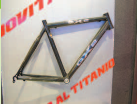
▲Oria的GX 2碳纖維管材，內含鈦合金絲，許多車廠與其配合開發自有管型。
