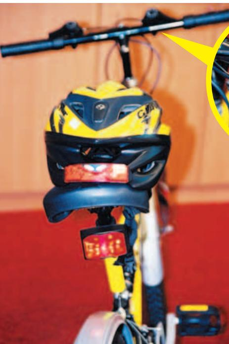
▲桑佛爾自行車第一煞車燈的發射器採用無線射頻高科技，讓後車燈在煞車時可同步亮燈，安全性更高。
